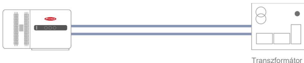
11. ábra: Az AC Daisy Chaining opció önálló alkalmazása két párhuzamos váltakozó áramú kábellel
