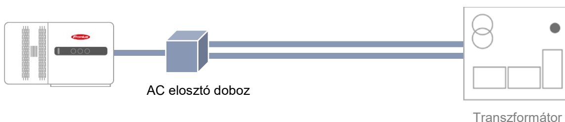
18. ábra: A Tauro ECO D változatát alkalmazó rendszerkialakítás nagy távolságok áthidalására
