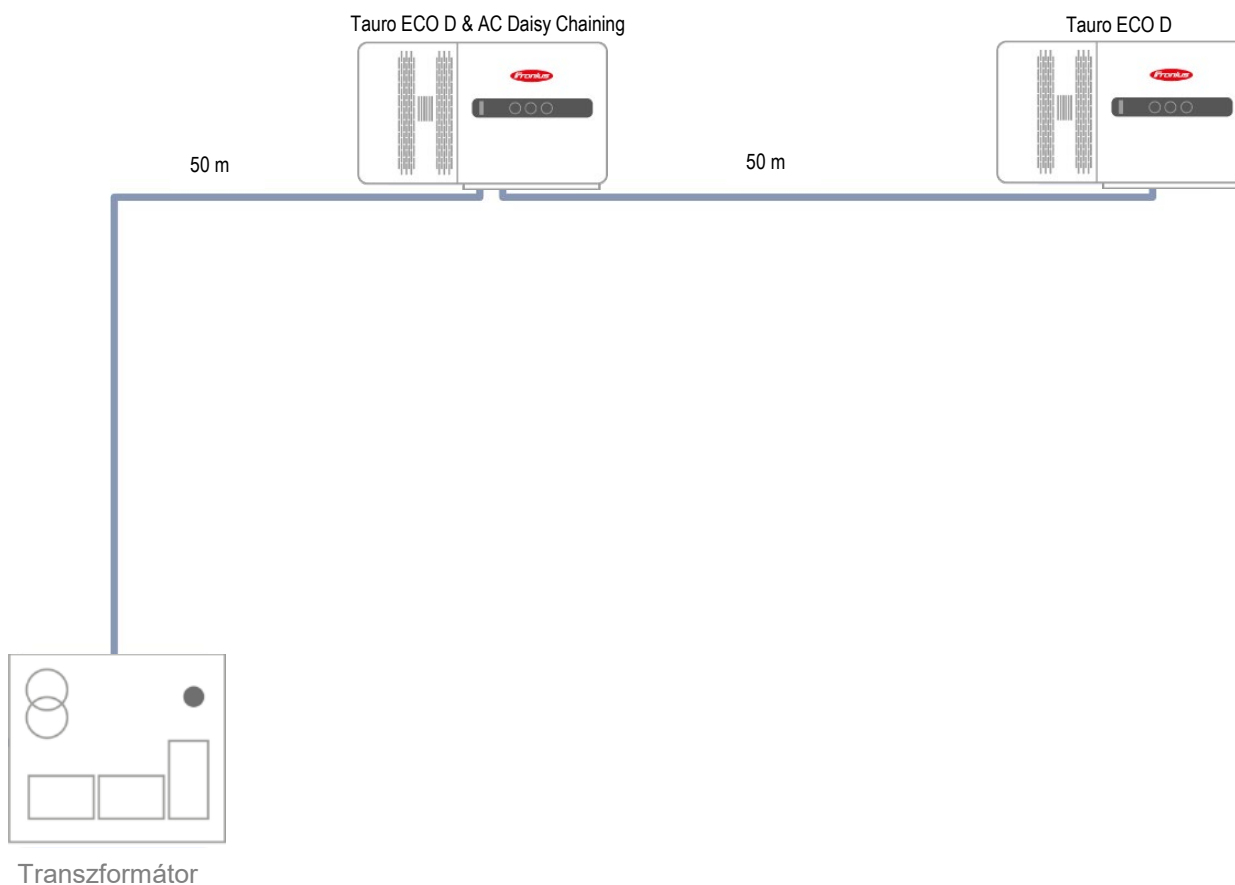
17. ábra: AC Daisy Chaining opciós Tauro ECO D és Tauro ECO D berendezést alkalmazó rendszerkialakítás
