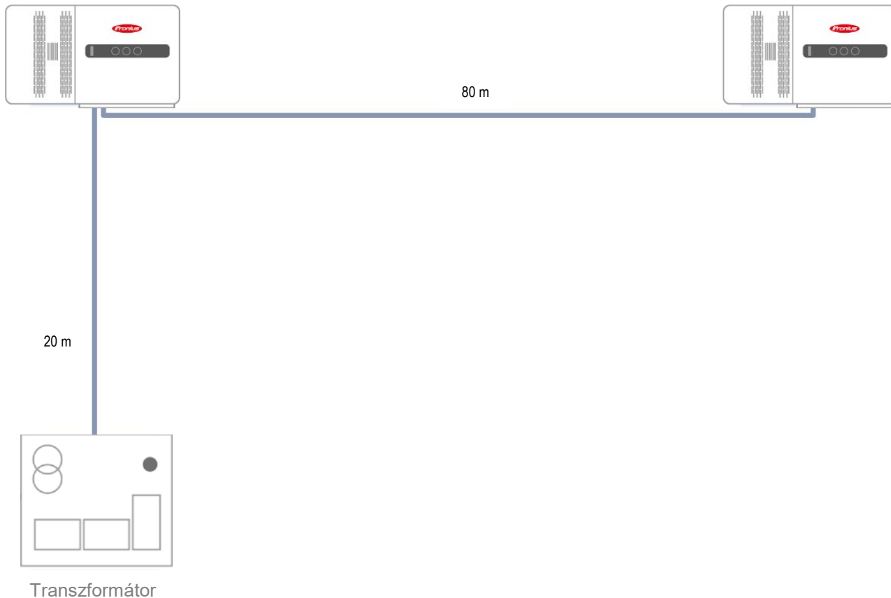
15. ábra: AC Daisy Chaining opciós Fronius Tauro ECO D és Tauro ECO D berendezést alkalmazó rendszerkialakítás
