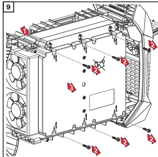
Débrancher la fiche à 16 pôles X1 du pack accus, retirer 6 vis TX 20, retirer le pack accus
