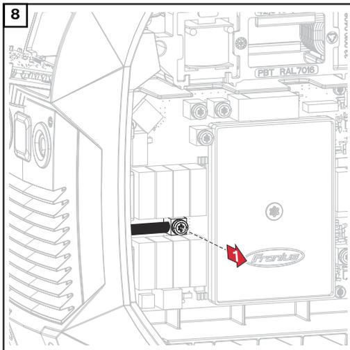
Retirer la vis TX25 et débrancher le câble d'alimentation (-) du pack accus ;
