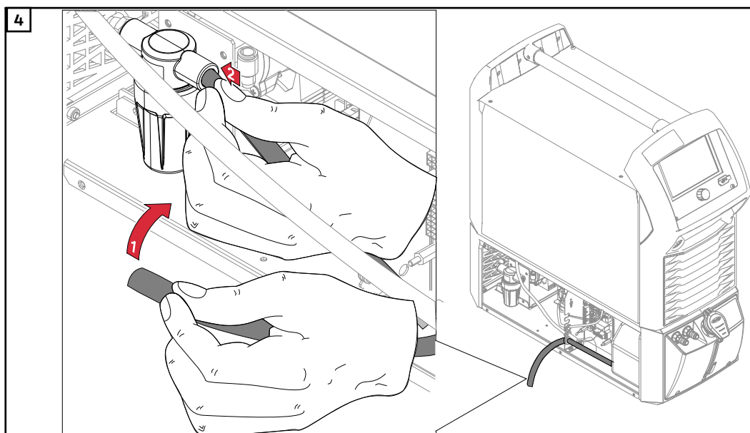
Insérer le tuyau de réfrigérant dans le préfiltre de réfrigérant
